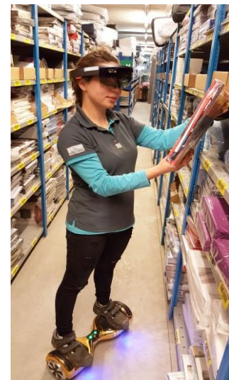
Figuur 6: Experiment met HoloLens mixed reality bril en hoverboard om productiviteit bij het orderpicken te verhogen.
