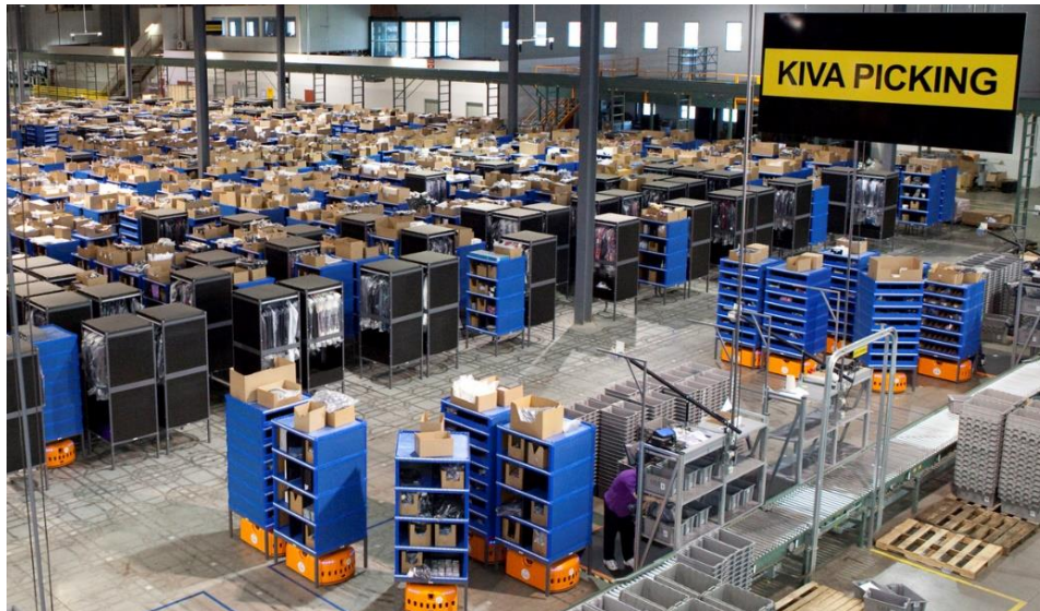
Figuur 3: KIVA-systeem, zoals in gebruik bij Amazon. Automatisch rijdende voertuigen (AMR's) verplaatsen stellingen en brengen deze naar de orderpicker (bron: internet).
