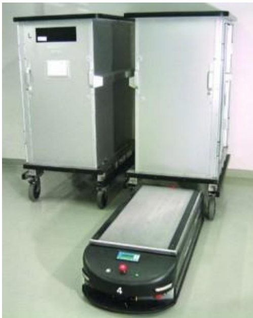
Figuur 1: Automatisch rijdende voertuigen (AMR's) verzorgen het interne transport in ziekenhuizen (bron: internet).
