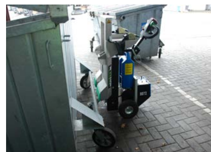
De one2move kan worden gekoppeld aan alle typen containers en wordt bediend door middel van een remote control. De chauffeur hoeft met de andere hand alleen de container bij te sturen.
