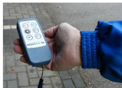
De one2move kan worden gekoppeld aan alle typen containers en wordt bediend door middel van een remote control. De chauffeur hoeft met de andere hand alleen de container bij te sturen.
