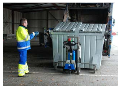
De one2move kan worden gekoppeld aan alle typen containers en wordt bediend door middel van een remote control. De chauffeur hoeft met de andere hand alleen de container bij te sturen.
