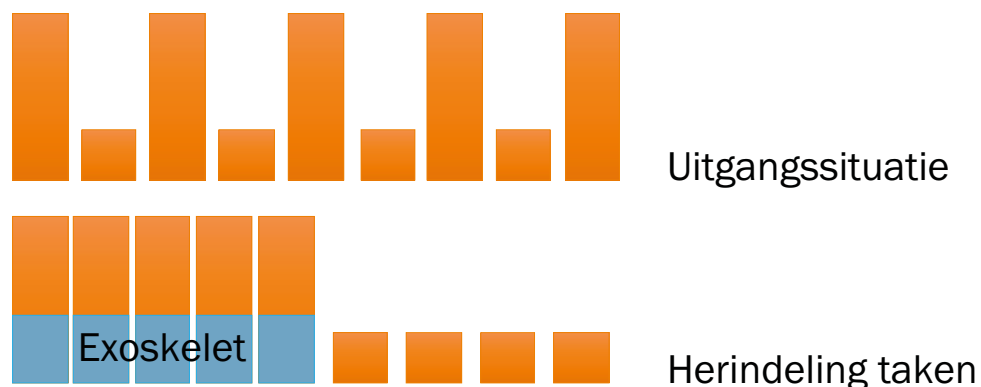
Figuur 8: Mogelijke taakverandering door exoskeletten: zware taken (hoge balk) worden gegroepeerd, zodat een exoskelet niet steeds aan- en uitgetrokken hoeft te worden.
