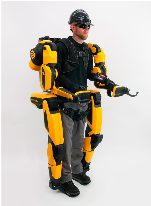
Figuur 4: De Sarcos Guardian XO, voorbeeld van een full-body exoskelet. Met dit exoskelet wordt momenteel geëxperimenteerd op een militaire scheepswerf (zie: https://www.sarcos.com/company/news/press-releases/u-s-navy-partners-with-sarcos-robotics/ )
