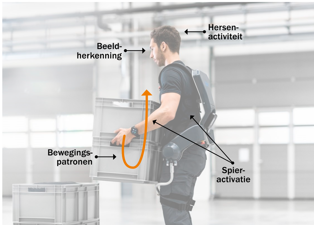
Figuur 10: Mogelijke bronnen voor het herkennen van de intentie van de gebruiker (foto: https://www.germanbionic.com/ )
